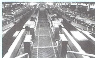
省力荷役のキメ手としてターミナルに設置された自動仕分け機
